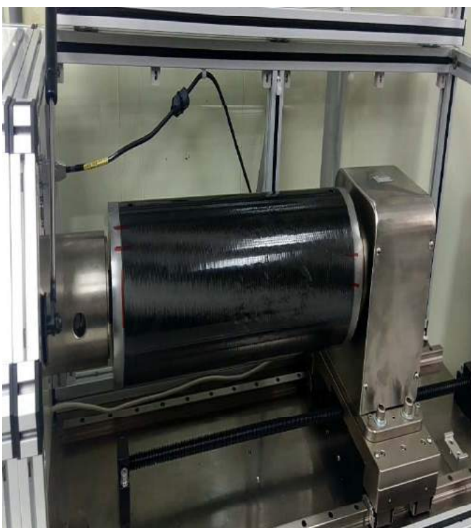
碳纖維材料長軸距聯軸器扭力測試
