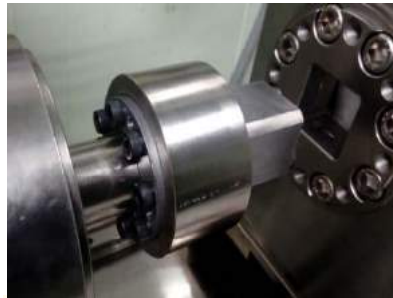
SDS自動校心軸套 測試
