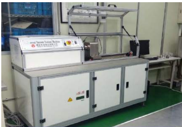
扭力測試及彈簧定數測試
